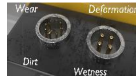
繰り返し挿抜によるピン曲がり・接触不良など、接続部トラブルを非接触接続により軽減
